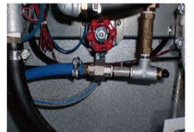
放水スイッチを入にして放水バルブを左に回し全開にする
