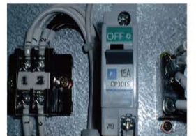
モーターに負荷がかかると内部ブレーカーがOFFになり、電源ランプが点滅する
