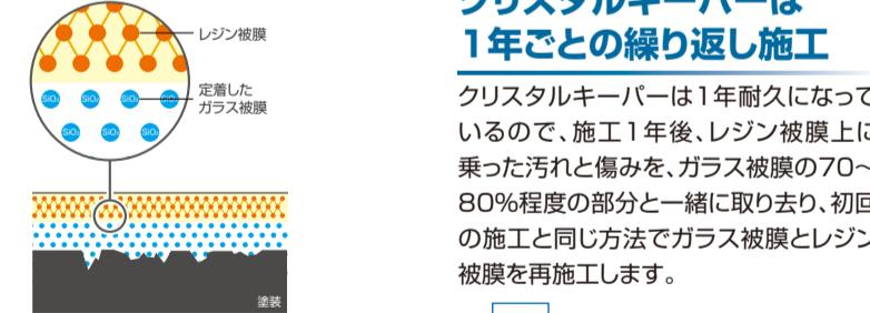
両方ともガラス特有の透明感あふれる独特のツヤ、しかも分子の細かい独自のガラス被膜なので、他のガラスコーティングと比べて圧倒的に色の深みが良く出ます。また、ともにガラス被膜の上にもう1枚、独特のレジン被膜を作つて二層構造にしています。このレジン被膜がよりツヤを深めるばかりでなく、ガラスコーティングの大敵である「水シミ(雨染み)」が固着するのをシャットアウトしています。
