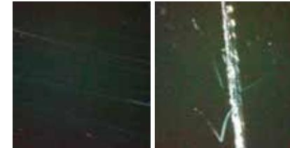
上の写真は2枚とも顕微鏡で撮った150倍の拡大写真です。左の写真は柔らかい布でそっと触っただけ付いた「キズ・(ヘアライン)」。右の写真はクリップの端をまったく押さえずに引いて付けた「傷」です。わずかですが明らかに塗装が削られて「傷」になっています。
