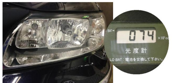
光度7,400カンデラと保安基準の「6,400カンデラ以上」をクリアした。見た目かなりキレイになっている
