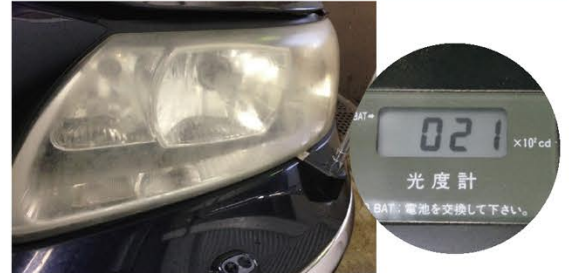
光度2,100カンデラと保安基準の「6,400カンデラ以上」を大きく下回っている
