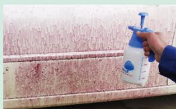
茶色い水垢部分に消雪パイプ錆クリーナーをスプレーし、5~10分放置。
