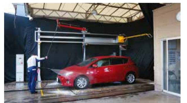
高圧水スプレーで、残った泡を、1周だけ回って流します。
