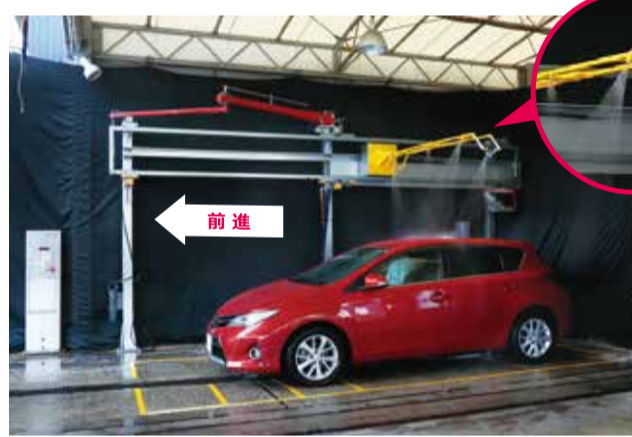
泡と水が出るブームは水平の一本のみ。ノズルの角度を吟味して、垂直の可動ノズルパイプを廃止しました。
