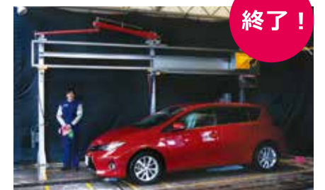
高圧水スプレーで、残った泡を、1周だけ回って流します。
