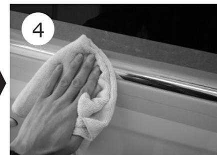
作業した個所をキーパークロスで拭き、白いシミが除去できているか状態を確認しながら作業します。
