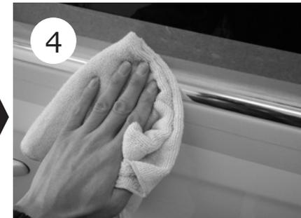
作業した個所をキーパークロスで拭き、モールクリーンシート青の磨き跡が整えられてるか確認しながら作業します。
